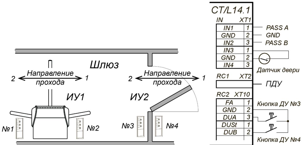
Рисунок 23. Схема шлюза из турникета и замка
