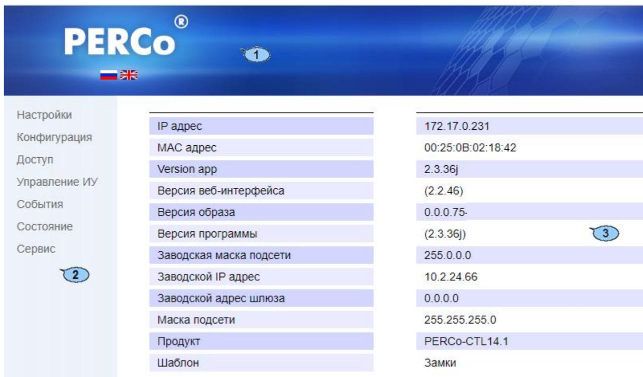
На главной странице отображается модель, конфигурация, сетевые настройки контроллера и версия встроенного ПО. При каждой загрузке главной страницы на ней отображаются текущие данные, считанные с контроллера. На странице можно выделить следующие элементы:
