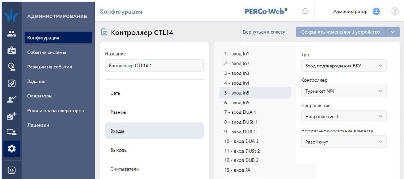
10. В рабочей области окна выберите вход контроллера, к которому физически подключен выход «ЗАПРЕТ» пирометра (например, **4 - вход In4**) и установите с помощью соответствующего раскрывающегося списка в рабочей области окна:
