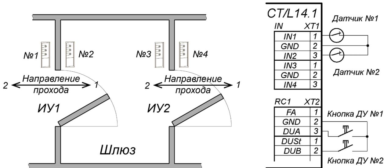
Рисунок 21. Схема шлюза из замков
