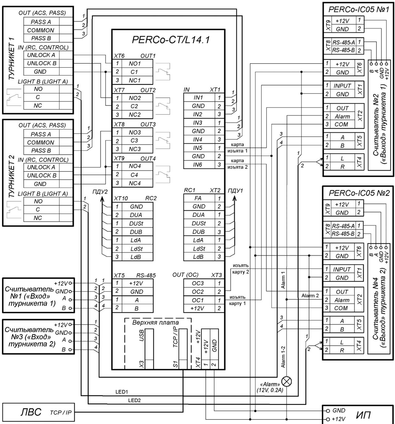
Рисунок 16. Схема подключения двух турникетов с картоприемниками PERCo-IC05
