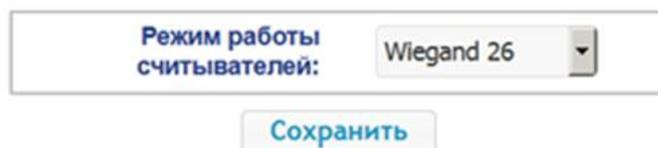
2. С помощью выпадающего списка **Режим работы считывателей** выберите один из предложенных режимов и нажмите кнопку **Сохранить**. Внесенные изменения будут сохранены.
