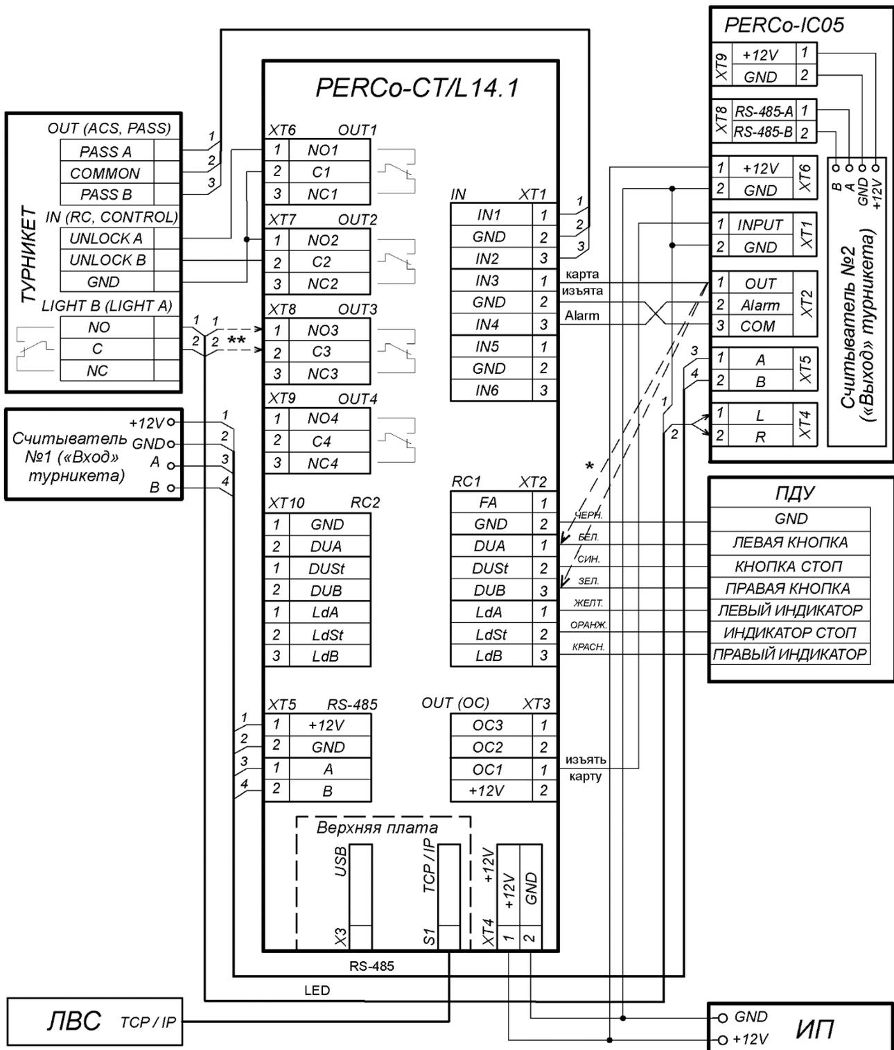
\* Если все дополнительные входы контроллера заняты, то выход картоприемника OUT (сигнал «Карта изъята») может подключаться параллельно ПДУ ко входу управления контроллера DU A или DU B в зависимости от направления прохода.
