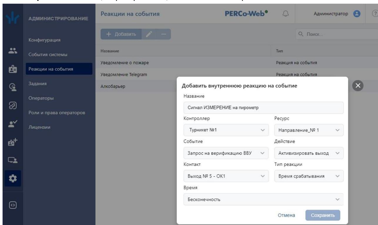
17. Нажмите кнопку **Сохранить**. Окно **Добавить внутреннюю реакцию на событие** будет закрыто, в списке реакций будет добавлена реакция, генерирующая сигнал ИЗМЕРЕНИЕ на пирометр при запросе на верификацию.
