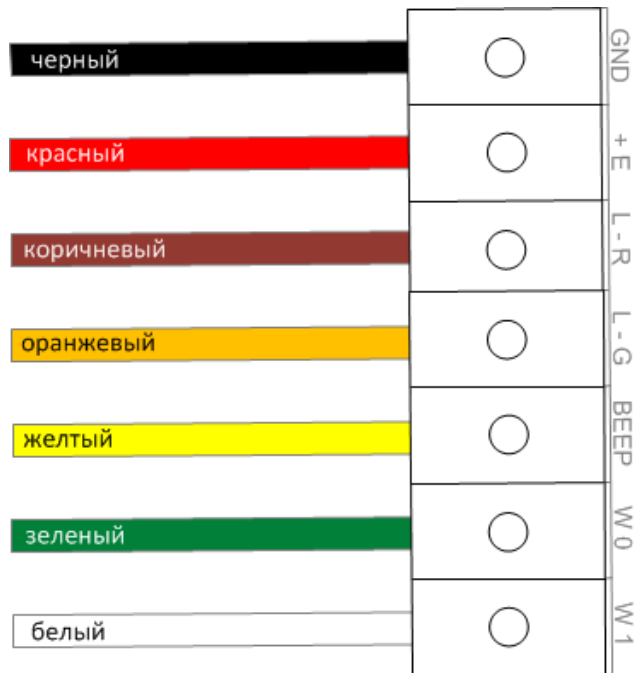
Рисунок 5. Подключение считывателя в режиме Wiegand 26
