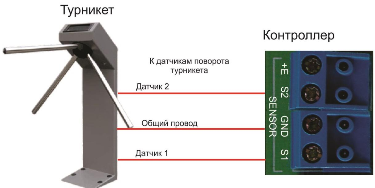
Рисунок 15. Подключение турникета с двумя датчиками поворота
