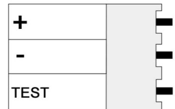
Рисунок 3. Назначение контактов разъема POWER
