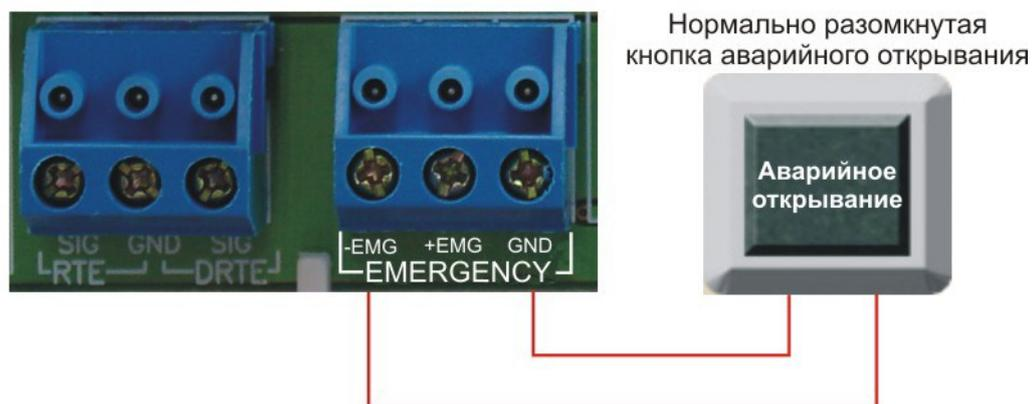
Рисунок 24. Подключение кнопки аварийного выхода к одному контроллеру
