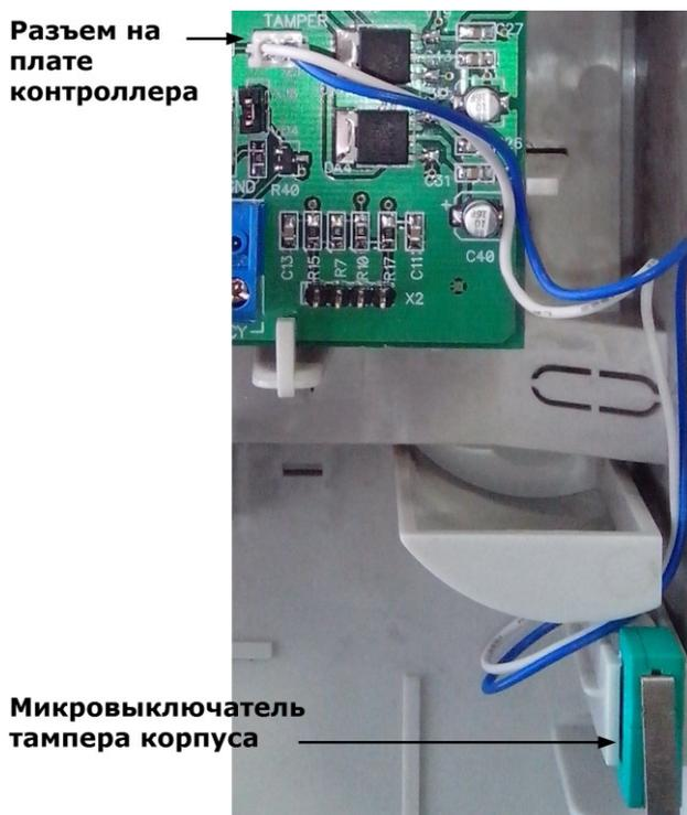
На плате контроллера имеется разъем контактов для подключения тампера (датчика вскрытия) корпуса контроллера (обозначен на плате контроллера как TAMPER). Тампер предназначен для сигнализации о вскрытии корпуса.
