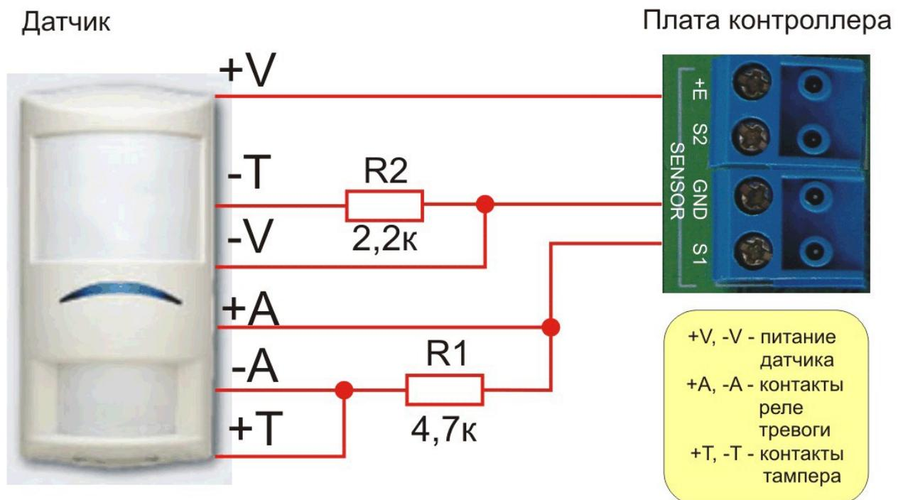
Рисунок 19. Подключение охранного датчика с контролем подводящих проводов
