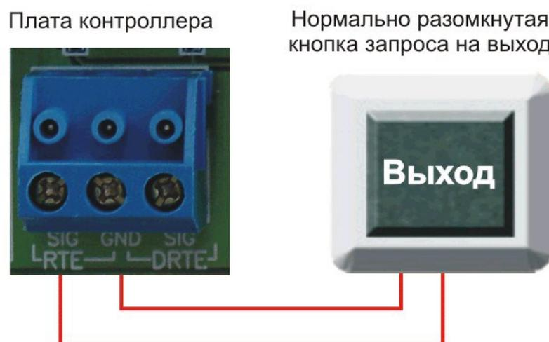
Рисунок 16. Схема подключения кнопки запроса на выход
