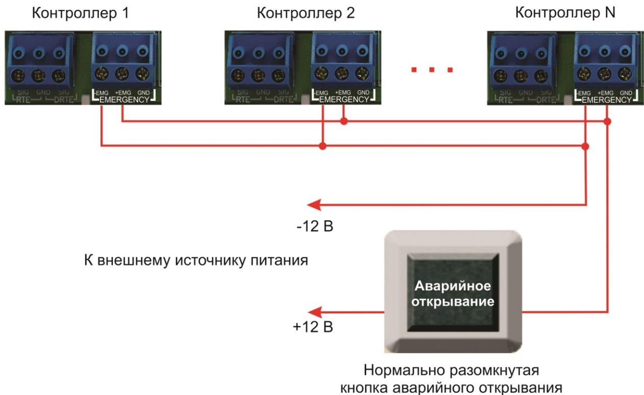
Рисунок 25. Подключение одной кнопки к нескольким контроллерам
