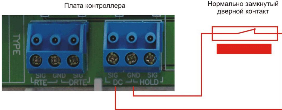
Рисунок 17. Подключение DC без контроля подводящих проводов
