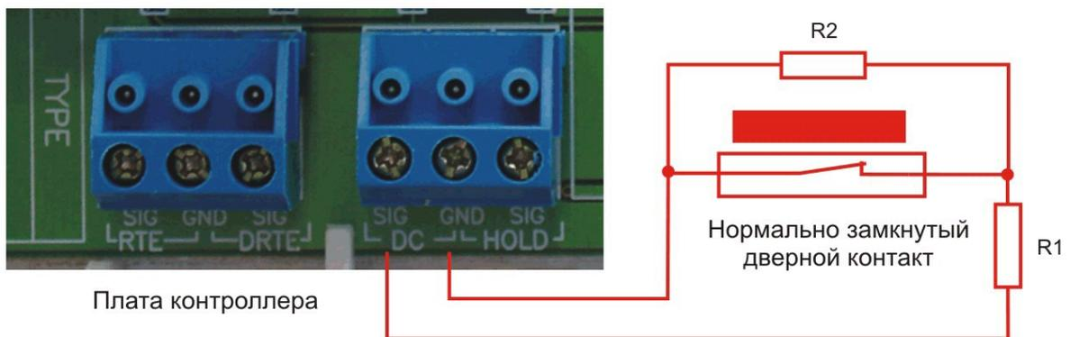
Рисунок 18. Подключение DC с контролем подводящих проводов
