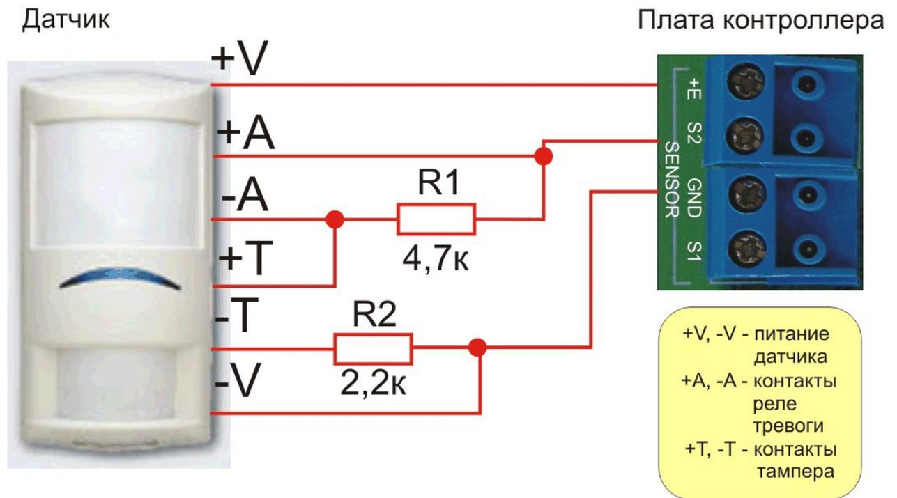
Рисунок 20. Подключение дополнительного датчика с контролем подводящих проводов
