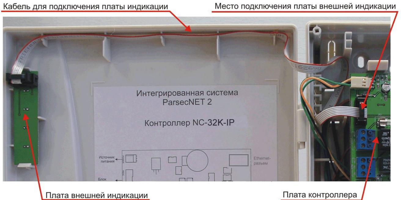
Рисунок 27. Схема подключения платы внешней индикации
