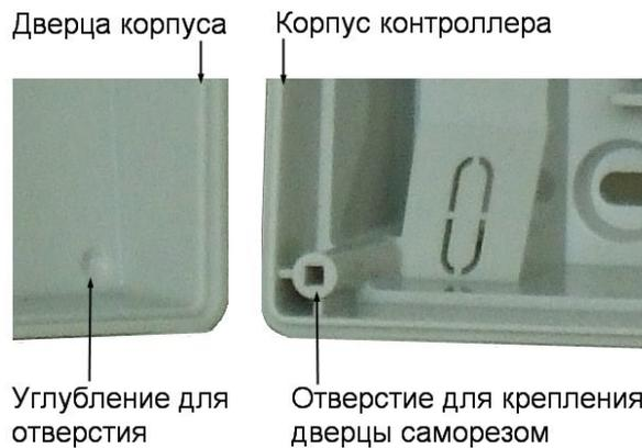
Рисунок 5. Схема «жесткого» крепления дверцы к корпусу контроллера
