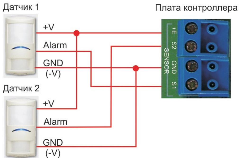
Рисунок 21. Подключение охранного датчика без контроля подводящих проводов
