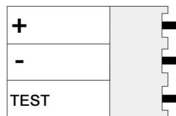
Рисунок 2. Назначение контактов разъема POWER
