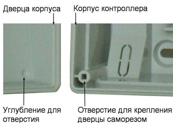
Рисунок 4. Схема «жесткого» крепления дверцы к корпусу контроллера
