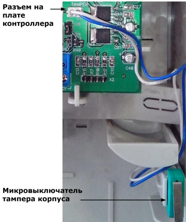
Рисунок 23. Подключение тампера корпуса
